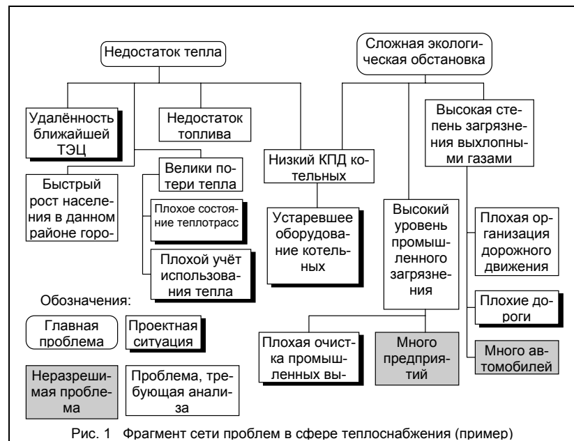
Рис. 1 Фрагмент сети проблем в сфере теплоснабжения (пример)
